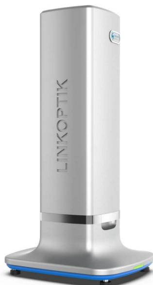
本产品是一款专门应用于快速测量薄片上的微孔直径的光学仪器，有效解决了传统方法光学采用显微图像处理技术和电子显微镜都无法实现对薄片微孔孔径全检的技术难题。其特点是对薄片全域范围（最大面积 5.0 x 4.5mm）的所有微孔只需一次抓拍，即可输出薄片上全部微孔的孔径特征、孔径分布和微孔位置分布图。
