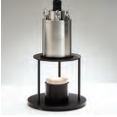
放在实验室支架上进行离线测量的非接触式探头
