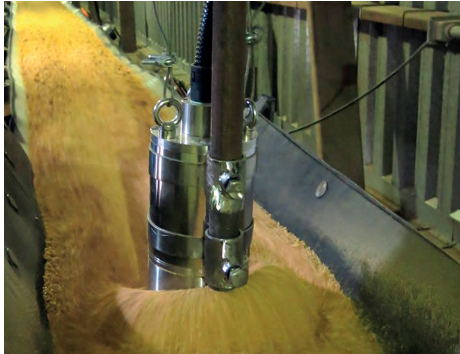
安装在传送带上的传感器探头，用于连续分析豆粕。
