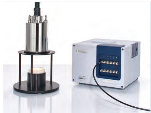
MATRIX-F II emission: 特别版MATRIX-F II光谱仪, 通过光纤连接漫反射探头, 仅用于非接触式测量。
