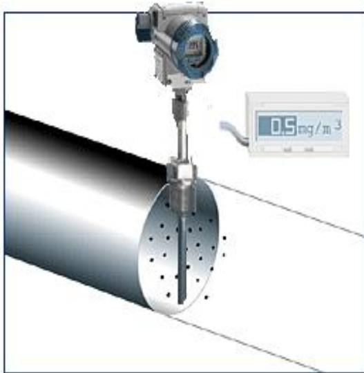
图 1 静电粉尘检测仪管道安装示意图
