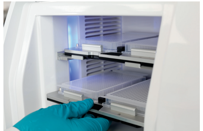
图 7. Biacore™ 8K 样品舱可同时放置 4 块 96 或 384 微孔板，并且可严格控温，以确保样品的稳定，并得到理想的检测结果。
