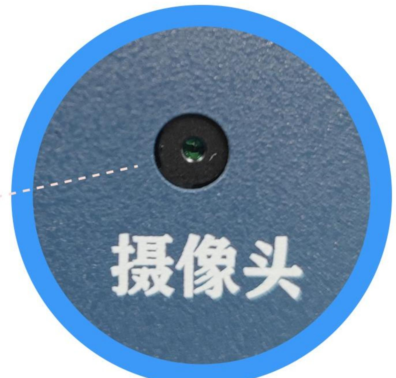
具有现场执法取证数字模块，配置高清摄像头，内置4G网络，支持Wifi, GPS定位，现场取证报告，并可记录、编辑操作人员及采集地点等信息；检测数据可实时上传天尔云平台及各监管平台，并在天尔云平台可永久储存，数据也可实时同步手机APP及PC端。
