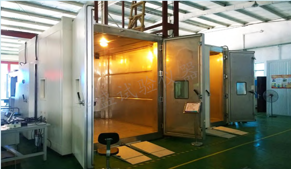
定制型组合式高低温（湿热）试验箱（中间隔断分为A\B两箱）
