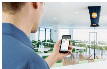
利用三脚架和应用程序, 轻松进行高天花板位置测量, 并可现场创建测量报告。
