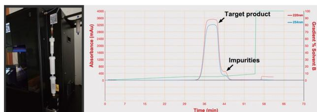
图1. 样品在2根标准型快速分离柱串联使用(左边)条件下的制备分离图谱(右边)。
