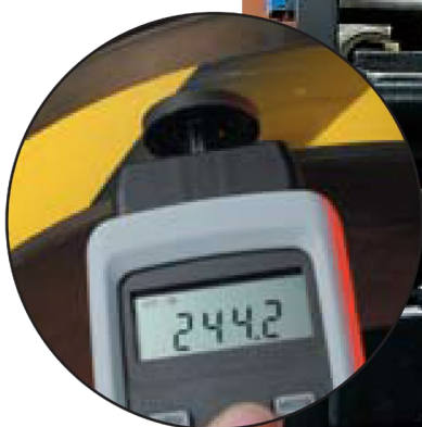
滚轮上的机械式转速测量
