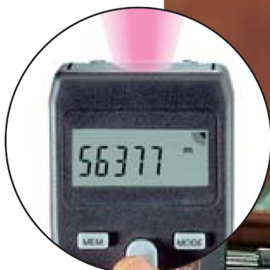
非接触式(光学) 转速测量
