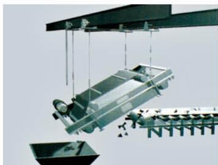
带式除铁器倾斜安装（轨道与皮带机垂直）
