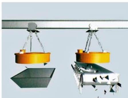
盘式除铁器水平安装（轨道与皮带机垂直）
