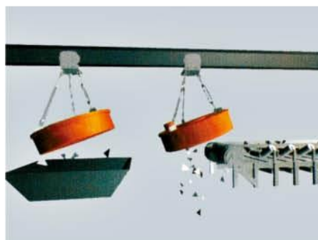
盘式除铁器倾斜安装（轨道与皮带机同向）
