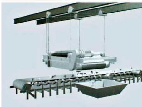
带式除铁器水平安装（轨道与皮带机垂直）
