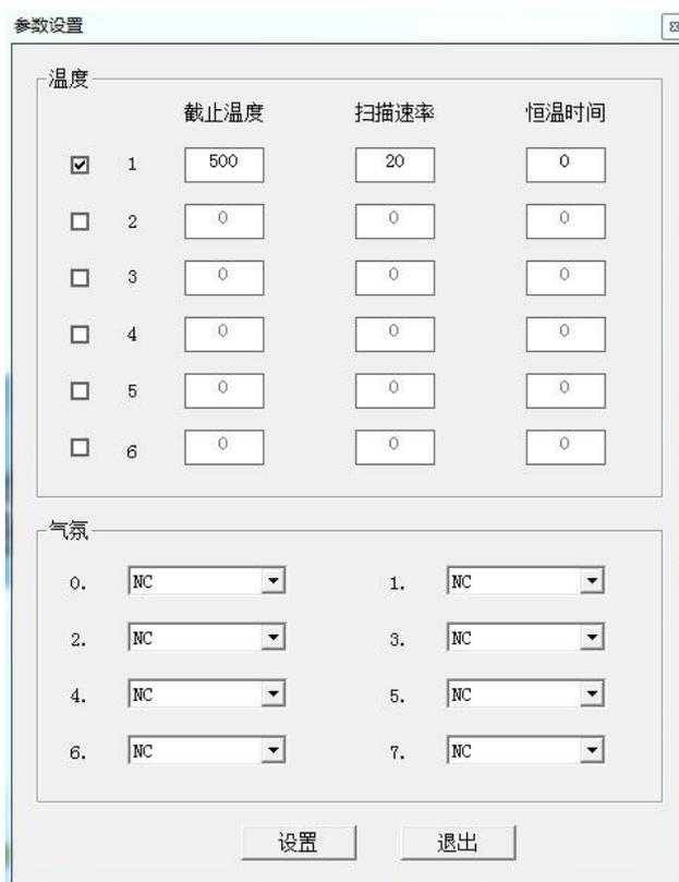
2. 所需参数设置完成，点击上图的【设置】键，同时 TG 质量稳定后点击软件上【运行】键
