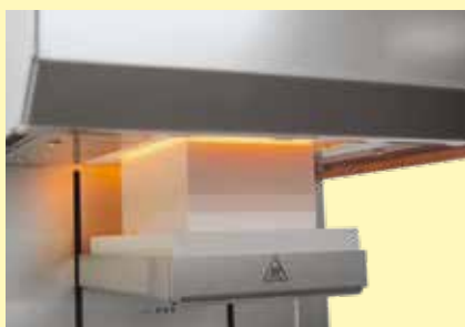
底部工作台自动下降以进行快速冷却
