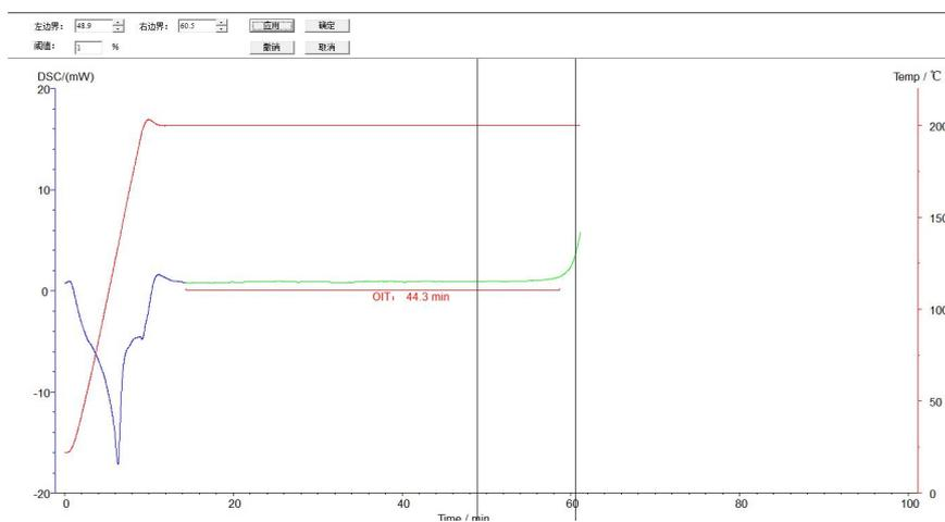
5. 4. 3 玻璃化分析操作：点击图谱使其变成绿色，即选定图谱，点击任务栏中【分析】—【玻璃化转变】—出现左右两根黑线，拖动左侧分析线在变化前端，右侧分析线在变化后端，选取好后，点击【应用】，【确定】，再点击该曲线，使其变成蓝色，分析完毕。分析好的图谱如下图
