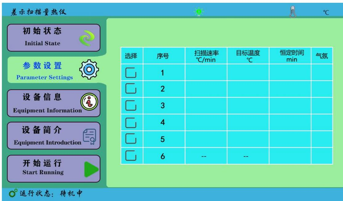
4.3 “设备信息”键，显示设备信息。管理员通道内部人员校准温度用的。
