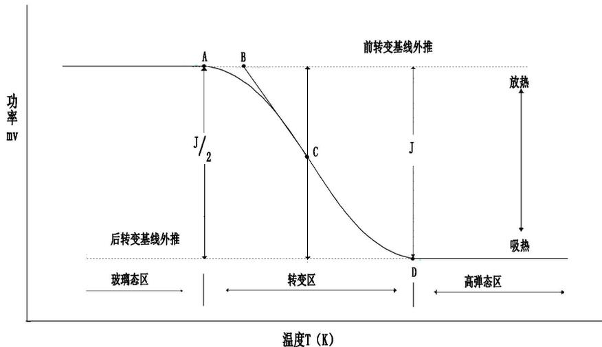
其他相变温度，如固化温度，结晶温度等同样的分析熔点的操作就可以。
