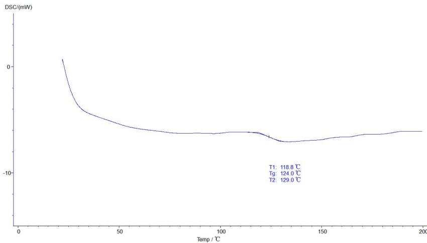
5.4.4 初熔点, 终熔点分析: 点击图谱使其变成绿色, 即选定图谱, 点击任务栏中【分析】—【初熔点】或【终熔点】—出现左右两根黑线, 拖动左侧分析线在变化前端, 右侧分析线在变化后端, 选取好后, 点击【应用】, 【确定】, 再点击该曲线, 使其变成蓝色, 分析完毕。分析好的图谱如下图:
