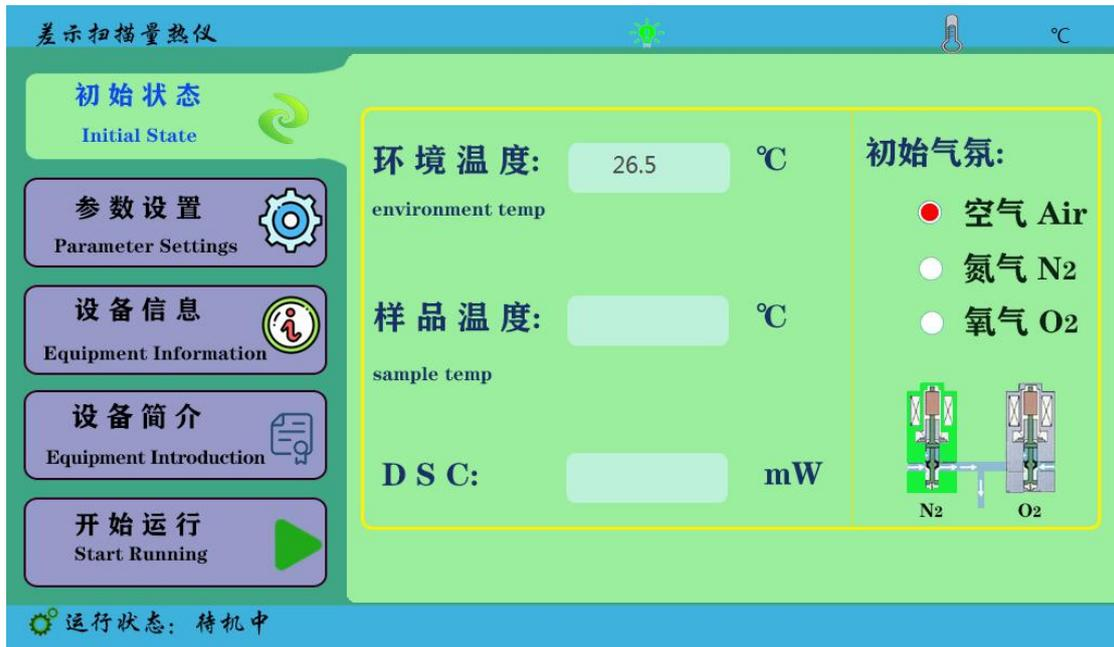
4.2 “参数设置”键，用来设置实验参数，一般在软件上设置。
