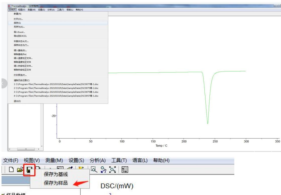
5.4.1 熔点，热焓，相变温度分析流程：点击图谱使其变成绿色，即选定图谱，点击任务栏中【分析】—【峰综合分析】—出现左右两根黑线，拖动左侧分析线
