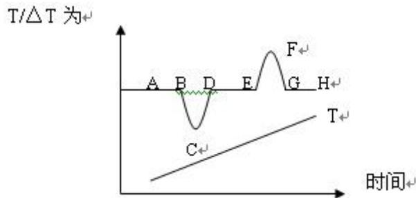
图中 T 是由插在参比物上的热电偶所反映的温度曲线。AH 线反应试样与参比物间的温差曲线。如果试样无热效应发生，那么试样与参比物间  $\Delta T=0$ ，则出现如曲线上 AB、DE、GH 那样平滑的基线。当有热效应发生而使试样的温度低于参比物，则出现如 BCD 顶峰向下的吸热峰。反之，则出现顶峰向上的 EFG 放热峰。
