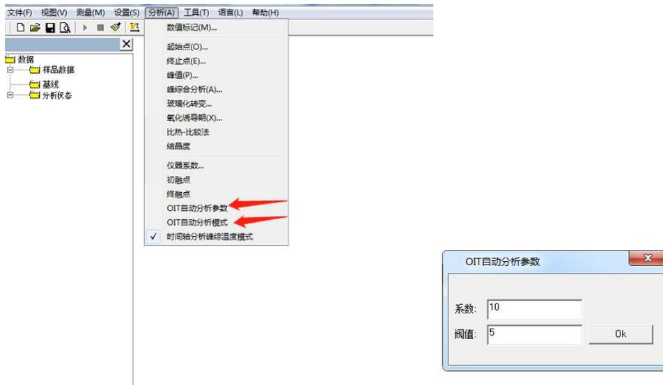
选择自动模式后，仪器会在软件检测到氧化放热峰后自动停止实验，并对数据进行计算得到 OIT 时间。
