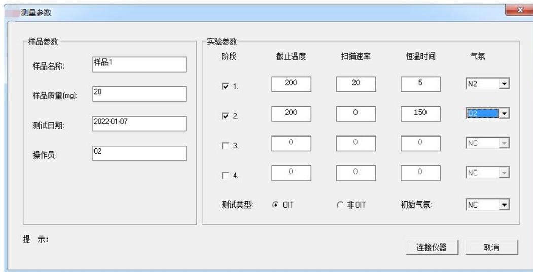
软件带 OIT 自动分析功能，勾选 OIT 自动分析模式，OIT 自动分析参数，操作步骤及分析参数设置如下图：
