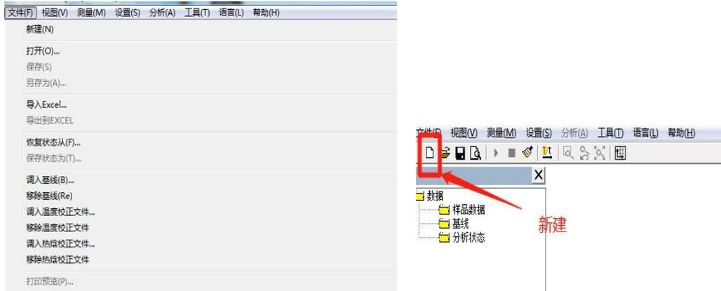
5.2 点击“新建”之后，会调转到新的窗口，在新建窗口内，输入【样品名称】，【样品质量】，【操作员】，【实验参数】，【气氛】等信息，测试类型根据客户需求选择【OIT】或【非 OIT】，点击【连接仪器】，会听到一声蜂鸣声。注意两次实验，样品名称不可以一样，否则会覆盖上次数据，导致上次数据的丢失。如下图：
