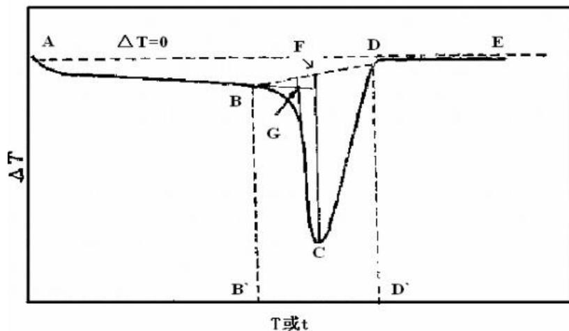
热焓是表示物质系统能量的一个状态函数，其数值上等于系统的内能  $U$  加上压强  $P$  和体积  $V$  的乘积，即  $H=U+PV$ 。在一定条件下可以从体系和环境间热量的传递来衡量体系的内能与焓的变化值。在没有其它功的条件下，体系在等容过程中所吸收的热量全部用以增加内能，体系在等压过程中所吸收的热量，全部用于使焓增加，由于一般的化学反应大都是在等压下进行的，所以焓更有实用价值。DSC 曲线中我们可以通过计算峰面积得到试样的熔融热焓，即图中的 BCD。
