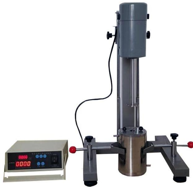
砂磨分散搅拌多用机是检测仪器，采用国内外新技术设计的新型产品，该产品集中了搅拌、砂磨、分散多种用途的功能于一体，砂磨分散搅拌多用机用电子恒力高速线路，数字直接显示转轴转速，并配有分散叶轮与砂磨叶盘。能适应实验室不同的试验需要，并可根据显示的转轴速度直接计算搅拌、分散、砂磨叶片的线速度与物料粘度及化学反应速率之间的关系，为大规模投产提供正确的数据。
