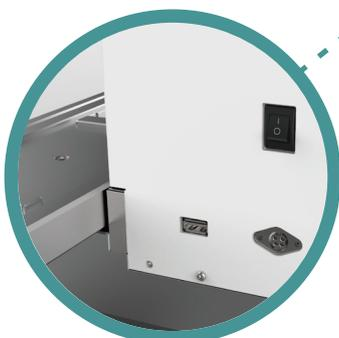
所有电子元器件均整合到机器内部，将220V交流电转换成24V安全电压，确保机器的安全性；体积小，可放入常规尺寸的超净台、安全柜和通风橱内。
