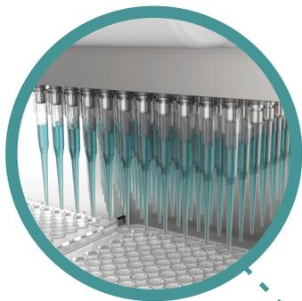
移液模块采用空气置换原理，经反复测试具有可靠的密封性和牢固性，确保每个移液通道完美的密封，无需辅助即可自动装/退整盒吸头，所以成为了用途广泛的实验室助手之一。1-20 $\mu$ l量程提供精准的小体积移液方案，5-200 $\mu$ l量程适合多数实验室的常规操作。96道同时移液，可在最短时间内完成96孔板的吸/放液，相比手动的8道移液器，速度提升12倍以上。
