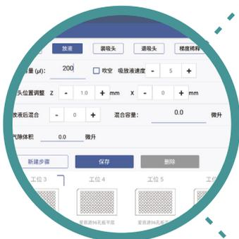
自主开发的软件，操作直观简便，不限数量的实验列表，预设多种移液模式，同时支持自主编辑实验流程并自动保存，所见即所得。在移液过程中，软件会控制移液模块对吸头进行精准定位，计算最佳的吸放液深度和角度，也支持用户自由调整吸放液的位置（X/Z轴）。
