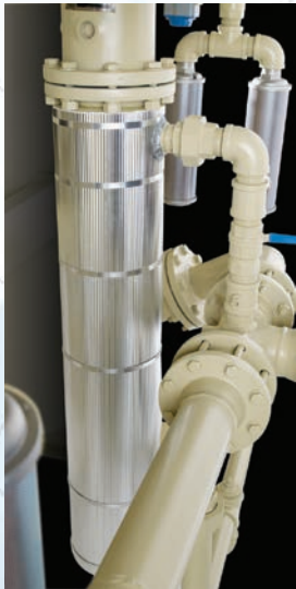
高效加热器减少了干燥剂再生所需的气量。
