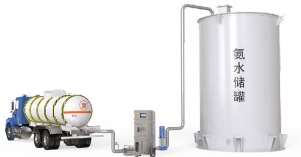
卸氨过程工作流程参考图
