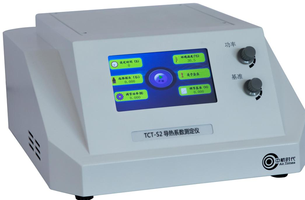
材料的热导率是研究材料物理性能的一个重要参数指标，在航空、原子能、建筑材料、非金属材料等工业部分都要求对有关材料的热导率，进行预测或实际测定。该仪器基于瞬态平面热源法的原理，以及相关国标要求，并做出了相应的改进，由计算机自动完成测试工作。满足了材料检测部门对材料导热系数的高精度测试要求。仪器参考标准：ISO 22007-2 2008
