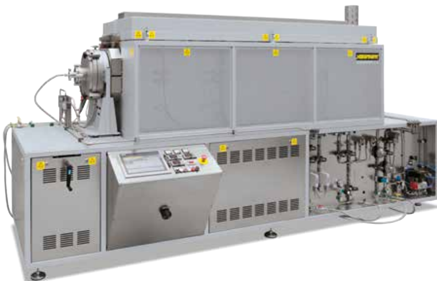
RSH 320/2000/09 H 2 , 带三区控温, 用于贵金属的热处理
