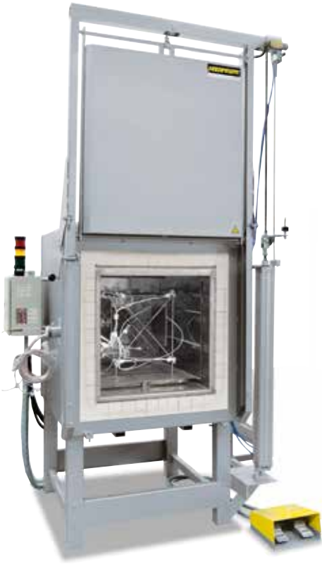
用来测量温度均匀性的测量架
