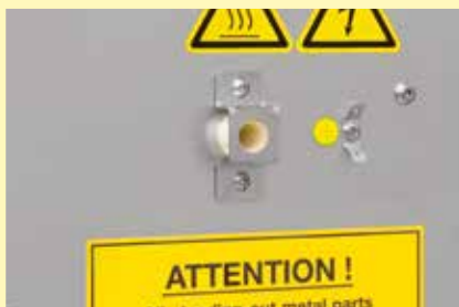
LV 5/11型灰化炉，炉后墙内配备热电偶套管
