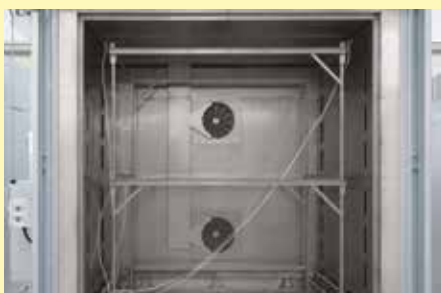
可插入式测试架用于N 7920/45 HAS型空气循环箱式炉的测试
