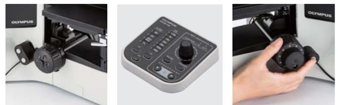
用于旋转动物镜转换器的手动开关
