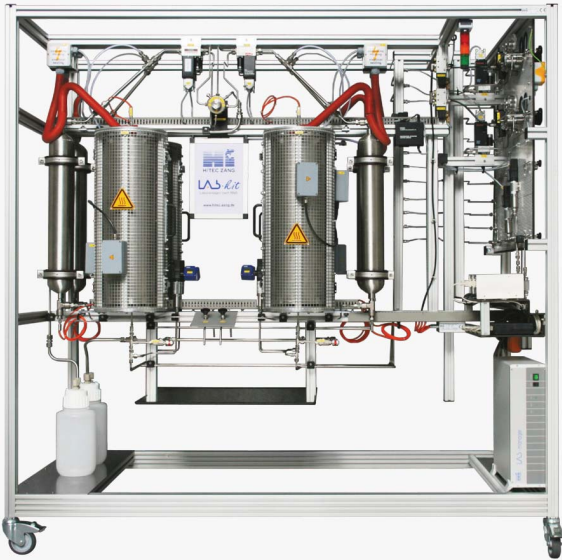
4路并行反应站,用于催化转化测试,压力最高达120 bar,3段式反应,持续运行
