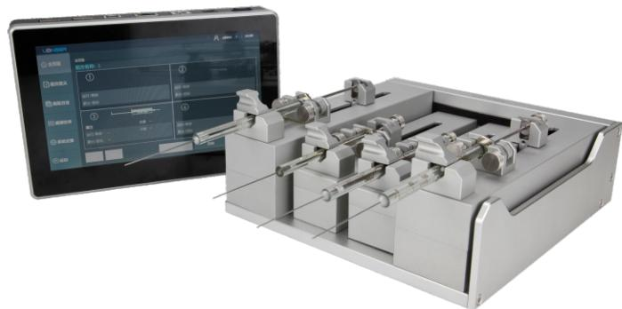
4通道底座提供磁吸式充电接头，易于多通道系统集成
