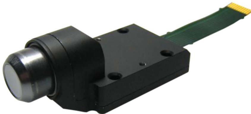
图 5. 硅漂移探测器 SDD
