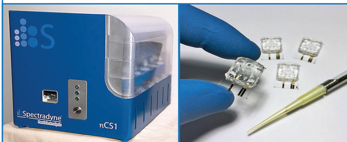
图 1: nCS1占地面积小, 大约1.5平方英尺 (左)。使用一次性微流体测试芯片 (右) 进行分析只需3μL样品, 可防止测量之间的污染无需清洁。
