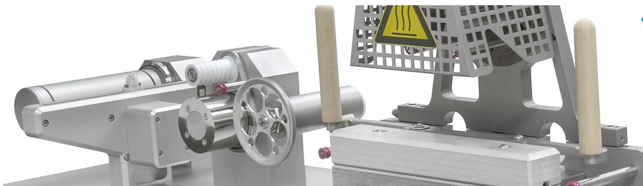
两个模块上的导轨的横向移动速度是独立控制的，以精确控制间距和绕卷松散与紧密程度。相邻纤维之间的节距可以控制在0.1毫米至4.0毫米之间。可用75毫米的纸管进行卷绕。拉伸/调节单元的纤维丝加热选项包括“热靴”（通过辐射加热纤维）或者任选地通过传导加热纤维的加热金属辊。
