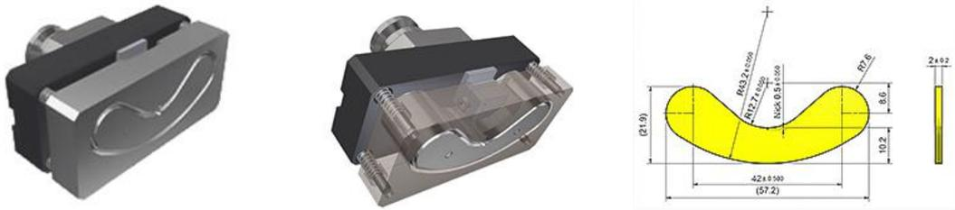
**用途：**依据 ASTM D624 A 标准，用于制作抗撕裂强度试验的测试样品。
