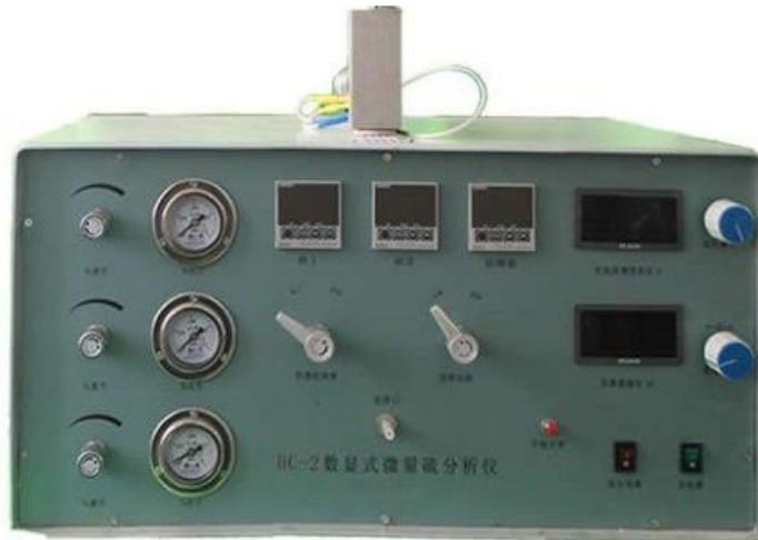
HC-2 数显式微量硫分析仪采用火焰光度检测器检测硫化物。以下分为 HC-2;HC-2B;HC-2H;HC-3; HC-5; HC-6 和 HC-7 等，它们分别适用于天然气，水煤气，半水煤气，焦炉气，食品级 CO<sub>2</sub>，黄磷尾气，石油加工副产品气等样品气中的硫化物的定性和定量分析。可分析的含硫化物：硫化氢；羰基硫；二硫化碳；二氧化硫；甲硫醇；甲硫醚；噻吩
