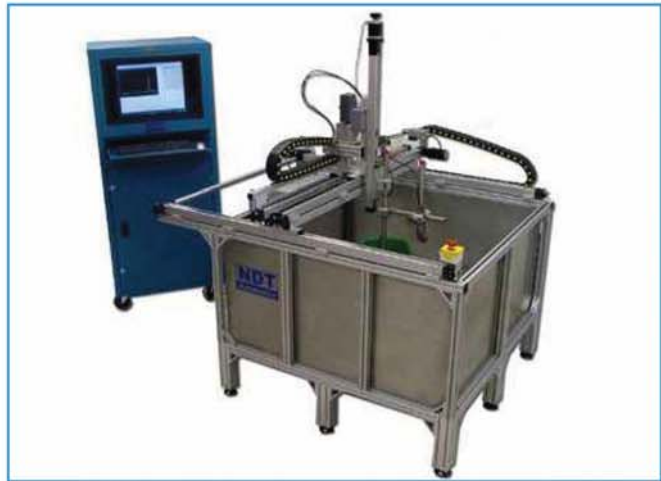
UPK-T48-HS(1200X900X600mm) 工业用/重任务型C-扫描检测系统
