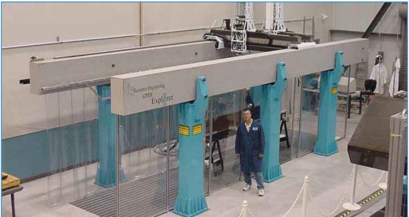
波音公司多轴大跨度喷水式扫描系统 12米长 x 4米宽 x 4米高. 喷水式
