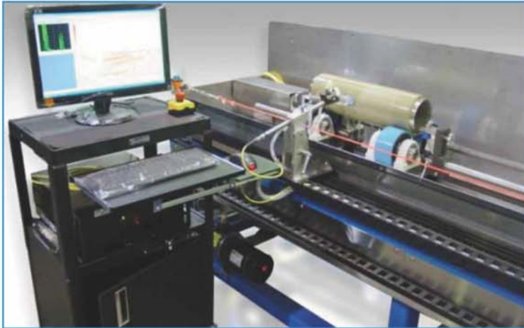
缠绕管道粘接质量C-扫描检测系统
