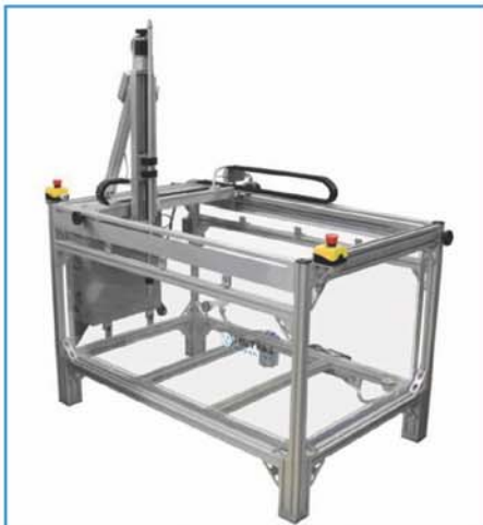
UPK-T36(900X600X450mm) 中等任务/实验室型C-扫描检测系统
