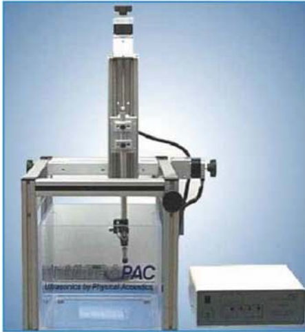
UPK-T10(250X250X250mm) 实验室型C-扫描检测系统
