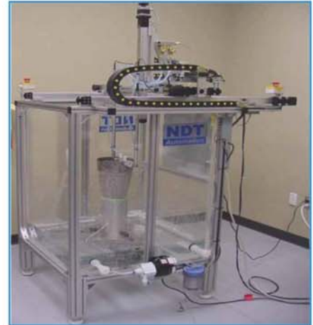
圆柱/盘/环类工件检测(可拆分式转盘装置)
