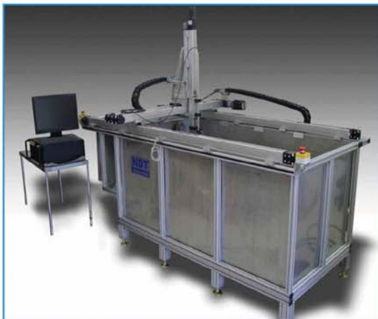
UPK-T60-HS(1500X900X900mm) 工业用/重任务型C-扫描检测系统
