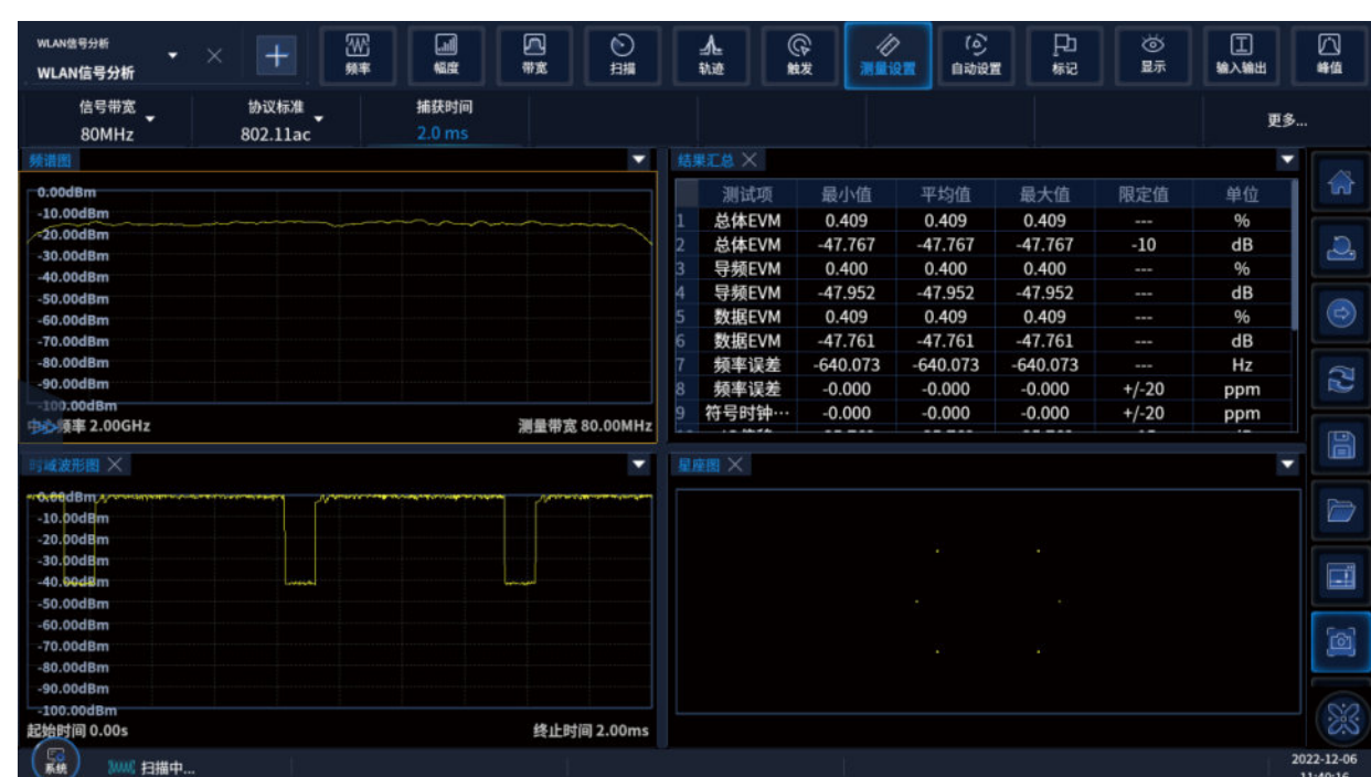
IEEE 802.11ac 单用户 PPDU 信号解调 EVM, 80MHz 传输带宽, QPSK+BPSK
