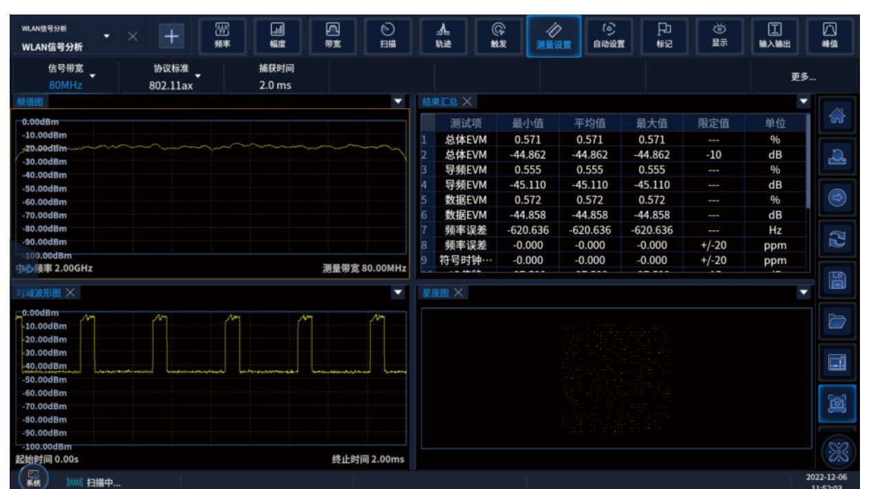
IEEE 802.11ax 单用户 PPDU 信号解调 EVM, 80MHz 传输带宽, 1024QAM
