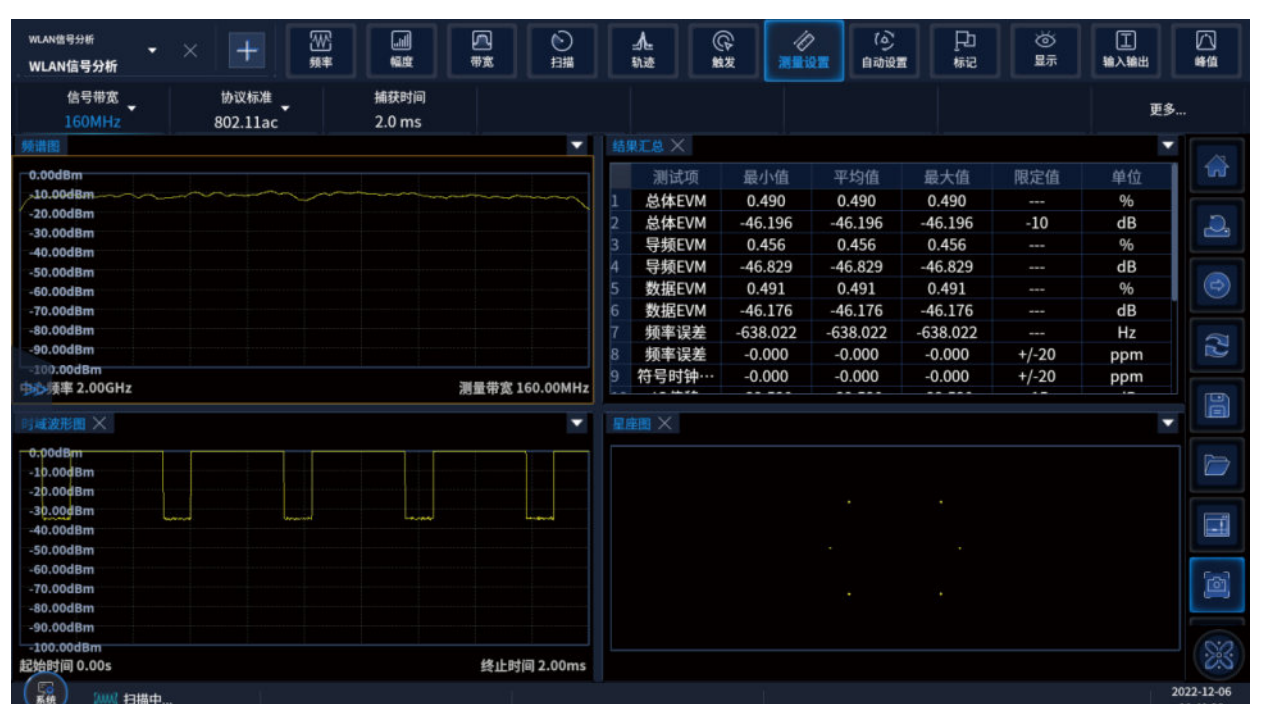
IEEE 802.11ac 单用户 PPDU 信号解调 EVM, 1600MHz 传输带宽, QPSK+BPSK
