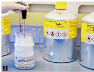
2. 使用脱脂装置，溶剂脱脂，简单方便，省时省力。一次可同时处理6个样品。
