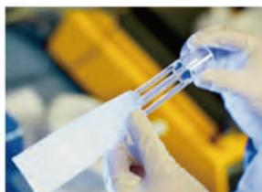
“FibreBag费伯包”法中，样品的消化和过滤步骤都在一个足够大的滤袋里进行，滤袋由特制的高精度纺织滤布制成，有利于把重重复复的过滤条件标准化。消化过程结束时，每个费伯包都与样品残留物一起焚化，如此一来，每个分析测定都是在相同的标准化过滤条件下完成，精确可再现的结果因此而生。
