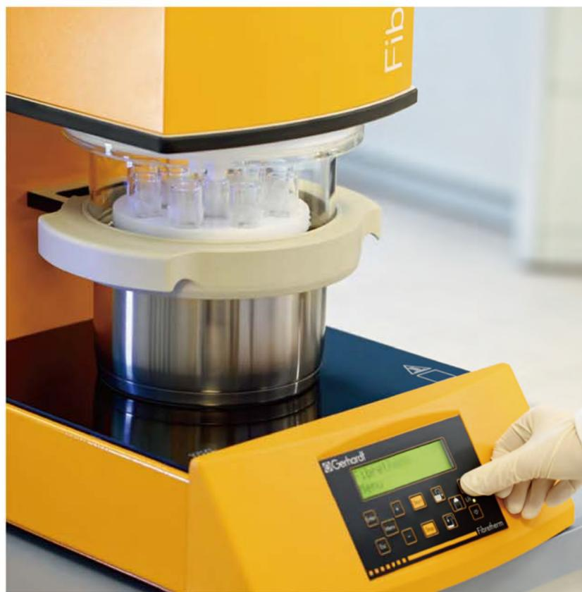
费博森FIBRE THERM使食品饲料各种纤维组分测定中费时费力的消煮和过滤过程自动化，符合温氏（Weender）和范氏（van Soest）标准方法，12个样品同时处理。费博森全自动纤维测定仪在一个自给自足的装置中全自动监控和操控消煮、洗涤和过滤的过程，相比于手工标准方法，充分体现出了其节能、节约试剂、节约时间的效果。
