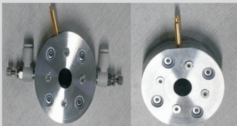
适合XAFS透射模式的电池原位池
