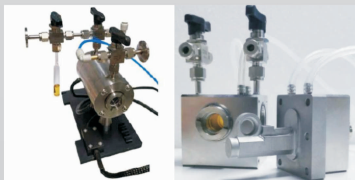
适合XAFS透射模式 离子空气电池催化原位样品反应池
