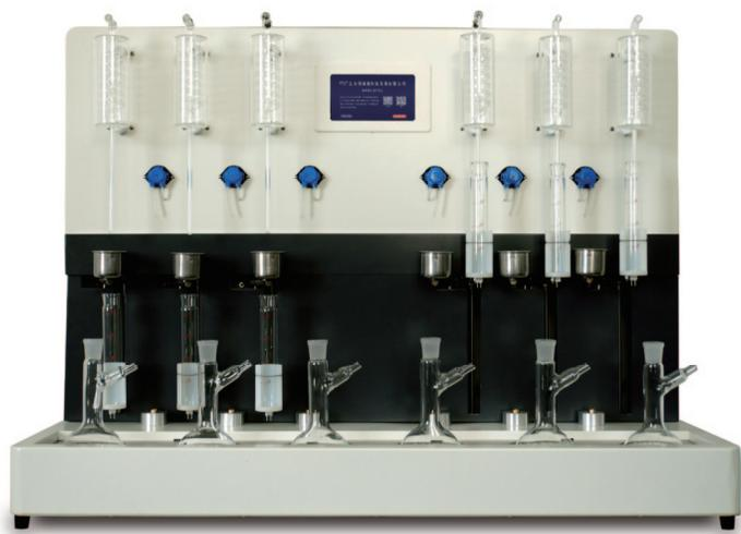
本公司根据国家生态环境标准HJ 1226—2021水质硫化物的测定-亚甲基蓝分光光度法;开发生产的一款全自动硫化物酸化-蒸馏-吸收装置。由微电脑控制自动完成蒸馏瓶加热、加酸、冷凝、吸收、清洗等全过程。提高了样品处理的准确性和工作效率。
