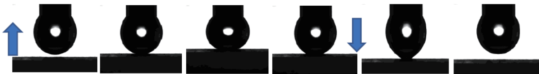
▲ 液体表面张力: 72.8 mN/m 液滴体积: 5 \mu l 最大粘附力: 45.9 \mu N
