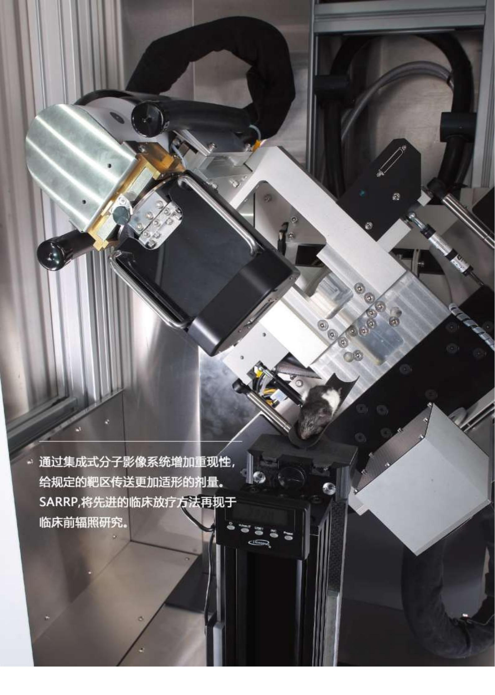
通过集成式分子影像系统增加重现性，给规定的靶区传送更加适形的剂量。SARRP,将先进的临床放疗方法再现于临床前辐照研究。
