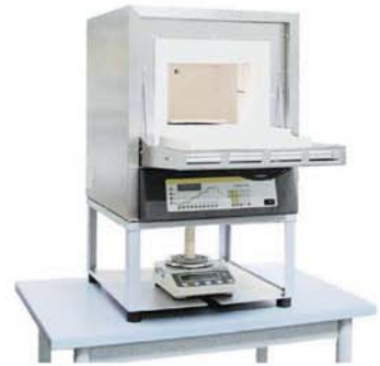
带失重系统的马弗炉
