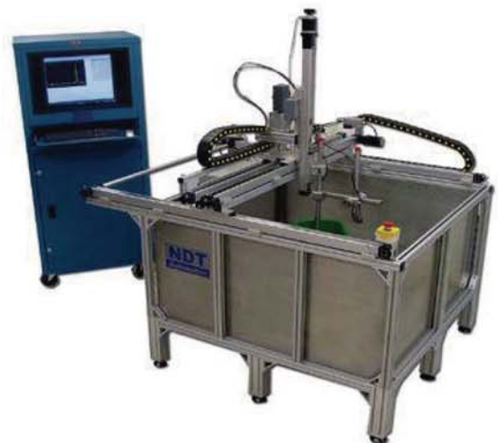
UPK-T48-HS ( 1200X900X600mm ) 工业用/重任务型C-扫描检测系统 金属构件检测
