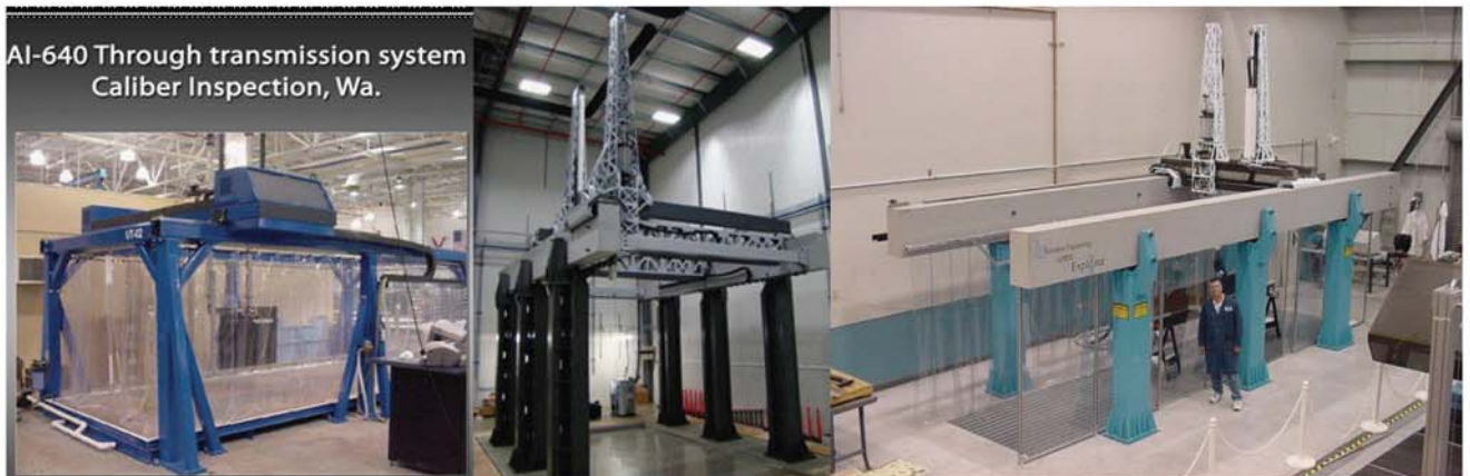
波音公司多轴大跨度喷水式扫描系统 12米长X4米宽X4米高，喷水式耦合，反射式或穿透式。12轴扫描（或更多）
