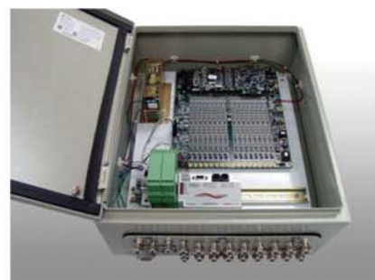
全天候在线检测系统SH-II(SHM)
