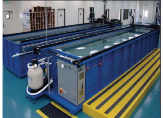
T240（工业型）有效行程6mX0.9mX0.9m，大型工业化系统设计，同步带传动，高速平稳静音
