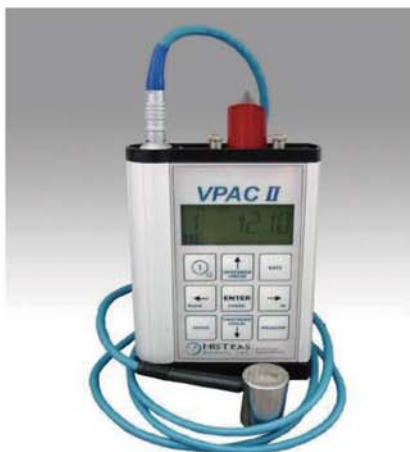
定量阀门泄漏检测系统VPACII
