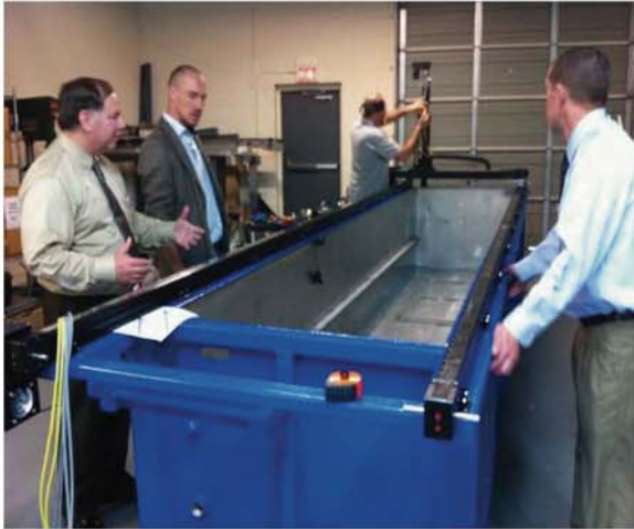
T156（工业型）有效行程4mX1.5mX0.9m，大型工业化系统设计，同步带传动，高速平稳静音
