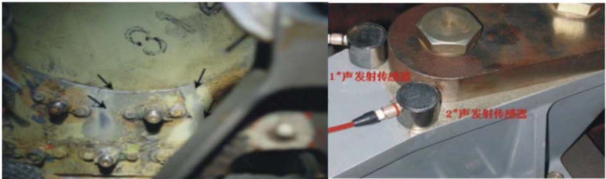
材料拉伸实验过程监测
