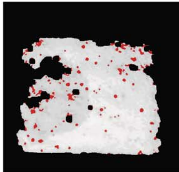
SMD 贴片电容的超声检测
