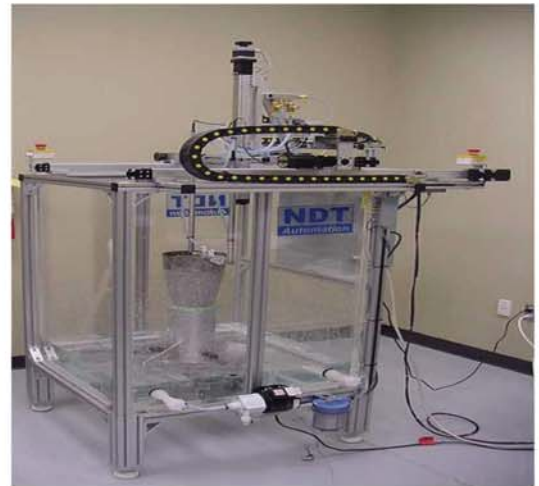
航空航天复合材料雷达罩喷水/水浸C-扫描检测系统
