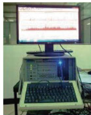
岩石三轴声波音发射一体化测试系统
