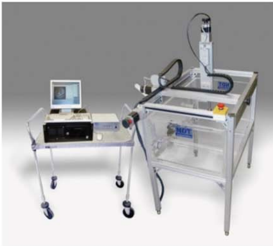
UPK-T24 ( 600X450X300 ) 实验室型C-扫描检测系统
