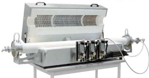
翻开式结构的带充气系统的管式炉，可充气氛保护也可抽真空
