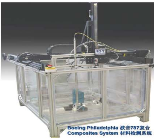
UPK-T48-HS ( 1200X900X600mm ) 工业用/重任务型C-扫描检测系统
