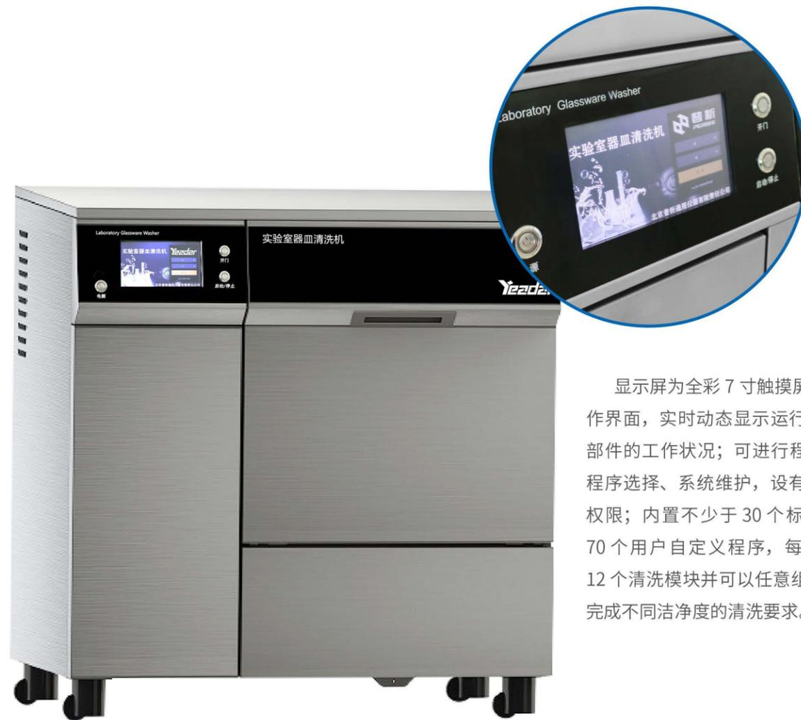
显示屏为全彩 7 寸触摸屏，中文操作界面，实时动态显示运行状态及各部件的工作状况；可进行程序设定、程序选择、系统维护，设有三级管理权限；内置不少于 30 个标准程序及 70 个用户自定义程序，每个程序有 12 个清洗模块并可以任意组合，可以完成不同洁净度的清洗要求。
