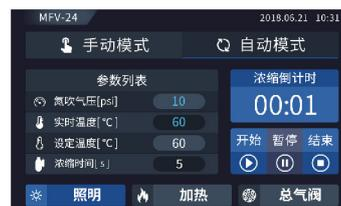
★ 终端选择联网后，可以通过DTLabs小程序上远程监控仪器运行状态，浓缩完成后自动推送通知提示。
