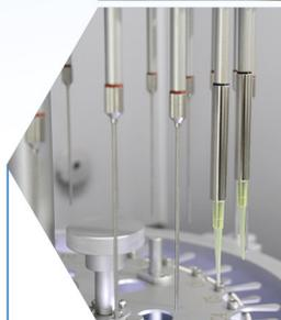
氮吹针一键升降，支持针头快换，可选配兼容一次性移液枪头的两用型氮吹针管
