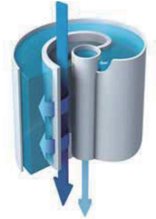
滤芯中先进的RO膜流向透视图。切向流降低了结垢的风险。
