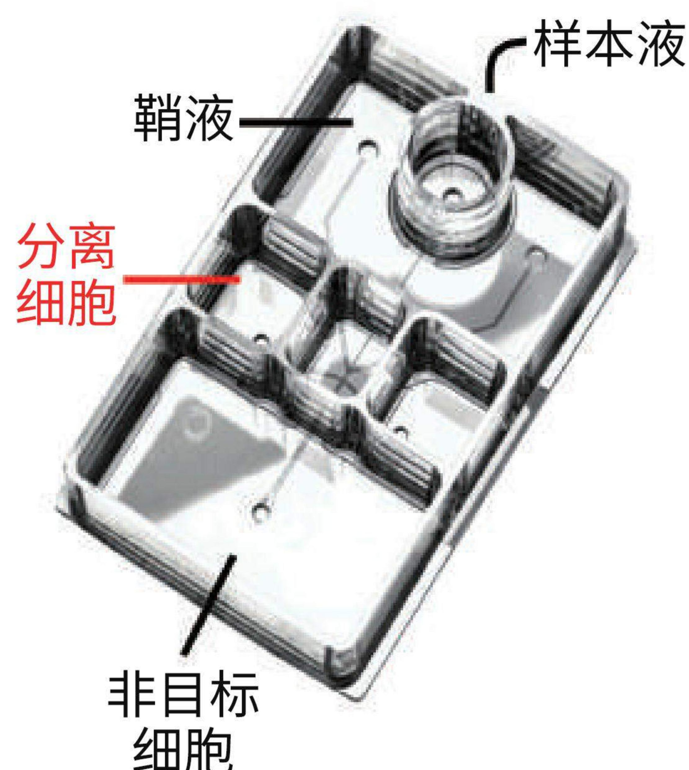
微流控芯片集成了样本的检测、分离、回收，实现小型化和简单化操作。从细菌、液滴(油中微小液滴)到相对大尺寸的细胞团块，本装置可检测广泛种类的样本。
