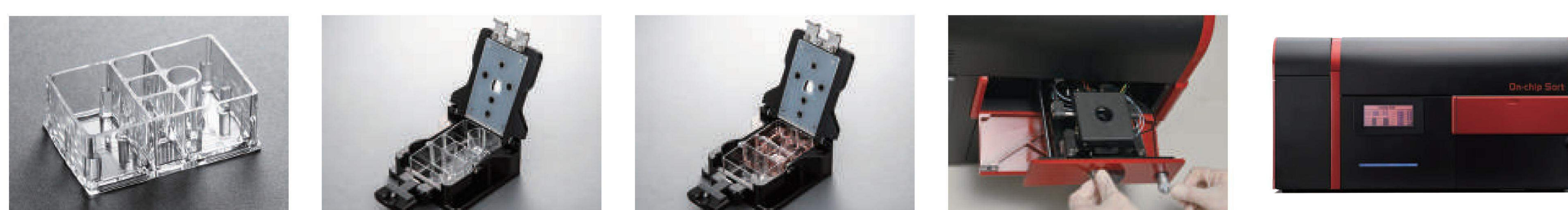
准备微流控芯片 → 将芯片装在固定器上 → 加入相关试剂 → 装载到仪器上 → 检测·分选 → 5分钟之内完成
