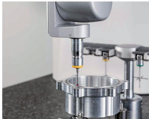
零部件表面形位的高精度检测
