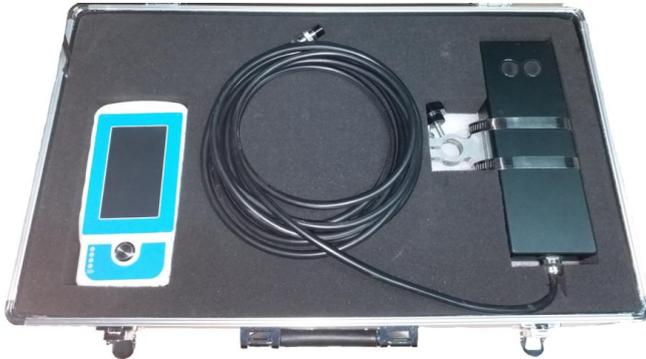
声学多普勒流速仪是应用于河流、明渠及管道等工况的流速流量检测仪器。其采用超声波探测技术，测量精度高、稳定性好、受环境因素影响小，无转动件、维护频次低、工作可靠性高，是便携流速流量测量的首选产品。
