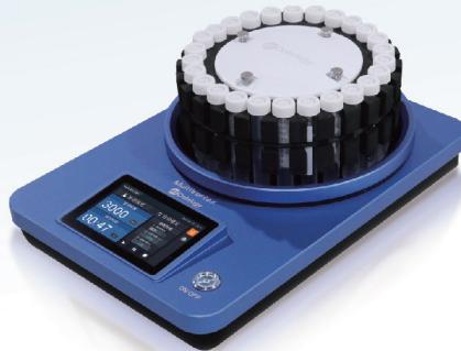
多样品涡旋混合器可以对不同规格样品管进行批量涡旋，主要应用为农残、兽残、添加剂、真菌毒素及环境等项目检测前处理，是实验室前处理不可或缺的仪器设备。
