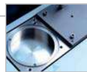
两个钛金属反应室 可以测定两个重复样本 或同时测定两个不同 样本
