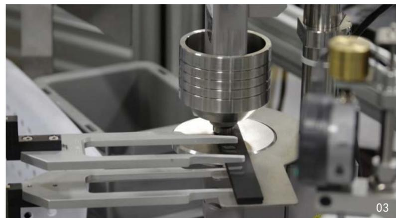
01 塑料试样夹爪 02 橡胶试样自动取样 03 集成硬度测试
