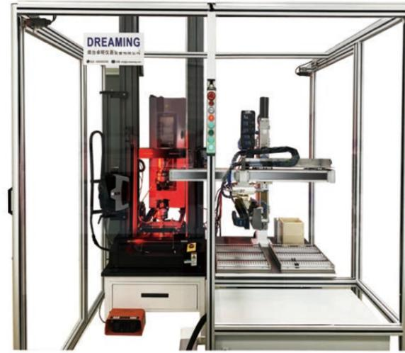
Servo Test-R 3轴伺服电缸式全自动橡胶材料试验系统
