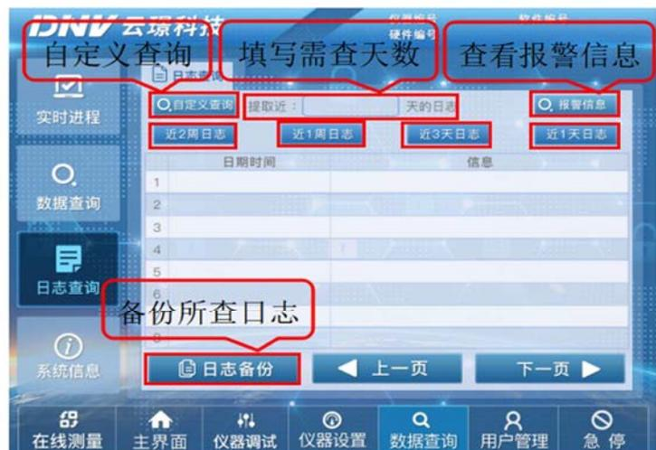
若需要拷贝运行日志，可以激活数据显示下方的【日志备份】按钮（备份请提前将 U 盘插入 USB 接口）。选择需要提取日志的时间节点，激活【日志备份】按钮后系统将会自动将运行日志以“.TXT”的格式备份到 U 盘的根目录“日志备份”目录下，备份完毕系统会显示“备份成功”，期间请耐心等待且不要断电或者拔出 U 盘以免造成数据丢失。
