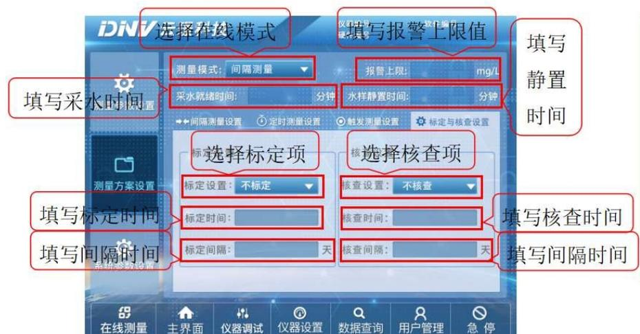
标定 b 和 K，不标定 b、标定时间设置不应与在线测量时间冲突。
