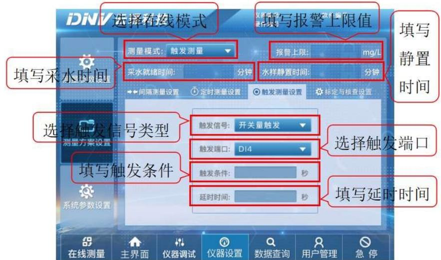
触发信号类型有串口触发，开关量程触发，网络触发，选用触发测量模式时必须选择触发信号类型。
