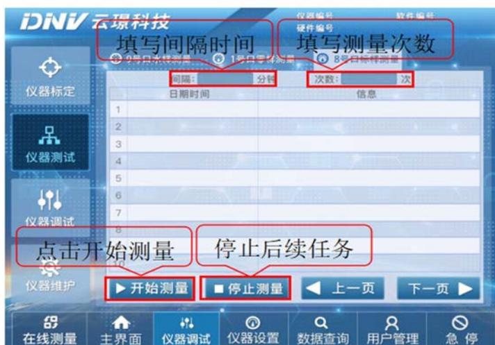
点击【开始测量】按钮后仪器会自动进行测量，测量数据在页面中央显示。需要停止测量可按下【停止测量】按钮。
