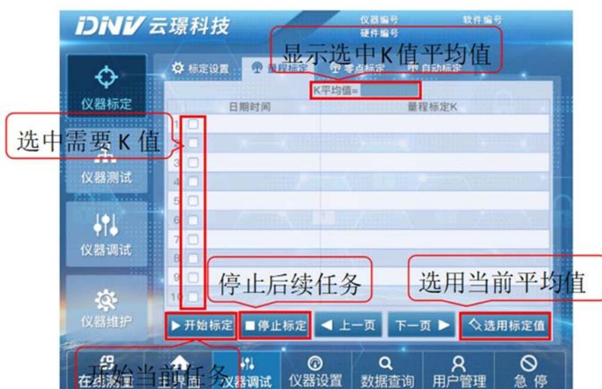
同 B 值标定步骤，点击【开始标定】按钮，仪器将自动开始校准 K 值，校准的 K 值结果将在界面中央由上往下依次展示在表格内，所得 K 值的平均值显示在表格上方。
