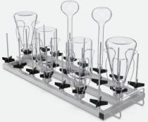
PLYT-21 喷淋瓶模块篮架 21 位 待清洗瓶尺寸：50 ~ 250ml 左右 用于清洗锥形瓶、容量瓶、烧瓶等 配有不锈钢三瓣花篮瓶托、十字瓶托 按照 250ml 容量瓶设计，每个模块能清洗 21 个
