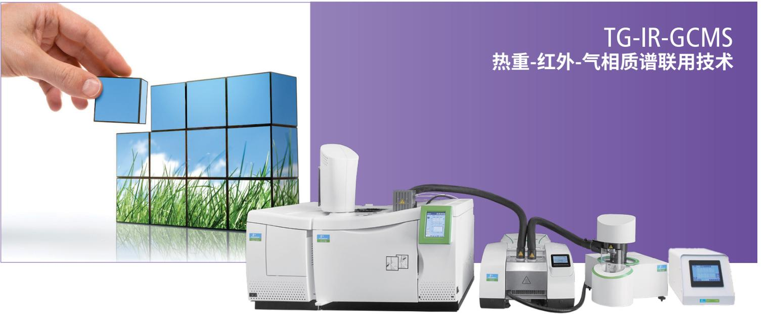
TG-IR-GC/MS热重红外气相质谱联用技术: TGA 8000与Spectrum 3 FTIR、Clarus SQ 8 GC/MS通过TL 9000e加热传输管线连接
