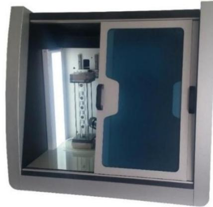
FOAMSCAN™具有智能模块化设计，可以研究泡沫性能。无论是通过气体喷射还是通过搅拌，FOAMSCAN™都可以精确控制发泡，从而实现可重复的、精确的和与工艺相关的测量，以及外部产生泡沫的研究。
