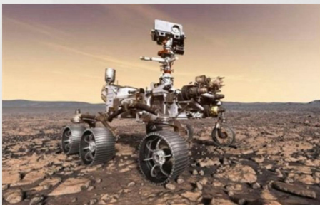
LIBS技术的典型应用：好奇号火星车上的ChemCam和创新号火星车上的SuperCam。
