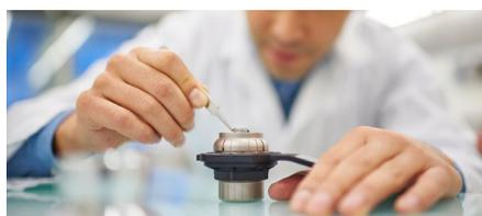
2. 装载样品 (打开舱门, 放入样品杯)
